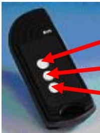
Taste für Rückwärtslauf der Mischschnecken (entspricht schwarzer Taste auf dem Steuerpult)
