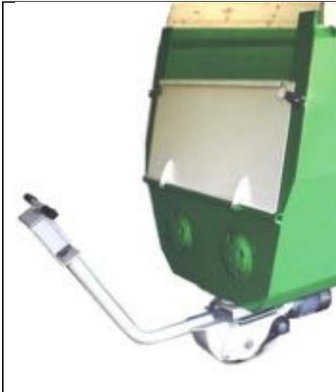
Befüllwand geschlossen und verriegelt.
