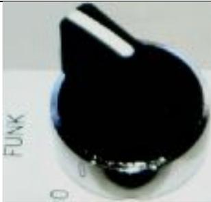
A black rotary switch with a white key. The switch has two positions, '0' and '1', with the word 'FUNK' printed vertically to the left.              | FUNK (Option)<br><br>0 Funk ist ausgeschaltet<br>1 Funk ist eingeschaltet                                                                               |
