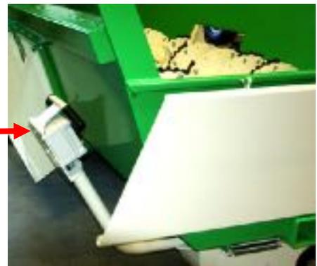
Wenn die Befüllwand geöffnet werden muss zur Befüll-Zufahrt z.B. eines Hoftracks, dann muss die Deichsel wegdreht werden.
