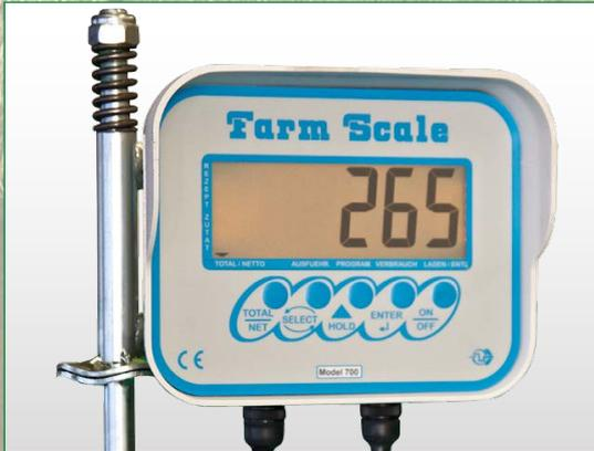
elektronische Wiegeeinrichtung, programmierbar mit Signalton & Anschluss für Funkdisplay, Display verstellbar in alle Richtungen
